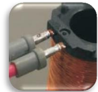
銅メッキ付端子溶接
